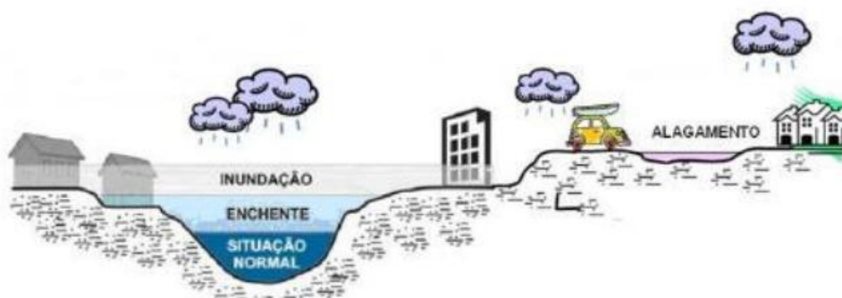
Figura 180 - Ilustração dos conceitos de enchente, inundação e alagamento
